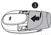
Pour remplacer les deux piles (1.2V AAA 400mAh Ni-MH), retirer le compartiment à piles et enlever les piles. Suivre les instructions précédentes pour installer les nouvelles piles.
