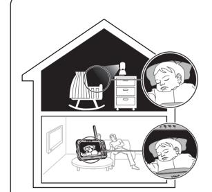
L'unité Bébé possède une caméra infrarouge qui s'active automatiquement lorsque l'intensité lumineuse de la pièce diminue. Elle permet de voir Bébé dans une pièce peu éclairée, ainsi que dans le noir total. Les images sont retransmises en noir et blanc sur l'écran de l'unité Parents et l'icône 📞 apparaît à l'écran.
