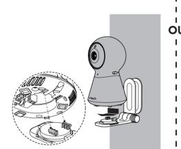
4. Alignez les oeillets de montage au dos de l'unité Bébé avec les vis fixées au mur. Faites glisser l'unité
